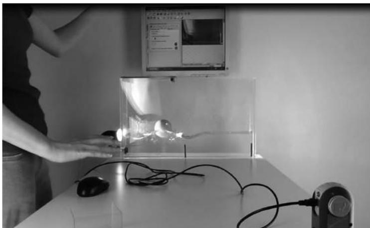
Figure 5 : Détection de la rotation d'un astéroïde. L'astéroïde (en blanc) tourne sur lui-même à l'aide d'un tournebroche. Un spot simule l'éclairage solaire. Un luxmètre (boîtier vert Globilab) mesure les variations de réflectance (quantité de lumière réfléchi par l'astéroïde) due à la rotation de l'objet. Ces variations sont visualisées sur la tablette via le logiciel d'acquisition associé au boîtier Globilab. Les élèves peuvent ainsi évaluer la période de rotation de l'astre.
