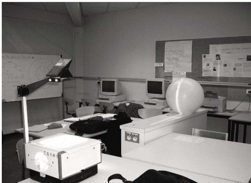
Le matériel : un rétroprojecteur, une boule dont il s'agit de déterminer le rayon, deux bâtonnets collés sur la sphère « verticalement ».
