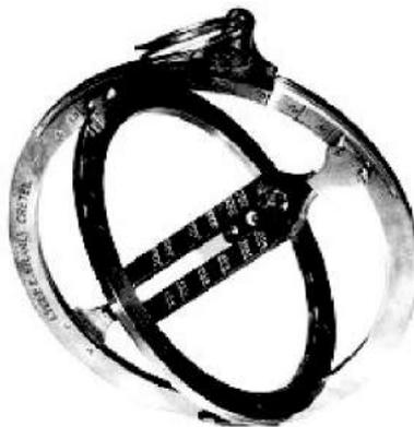
L'anneau astronomique fabriqué, en laiton, par nos élèves est un anneau d'Oughtred. Il mesure 14 cm de diamètre.
